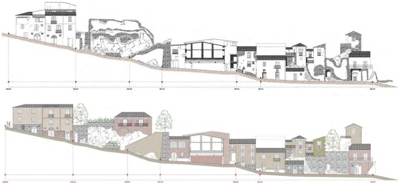
Fig. 6 – Studio di fattibilità per il recupero e la valorizzazione del Borgo medioevale di Via Castello. Profili longitudinali sul tratto interno di Via Castello, allo stato di rilievo e nel progetto di ricomposizione – Fonte: archivio grafico di G. De Pascale
