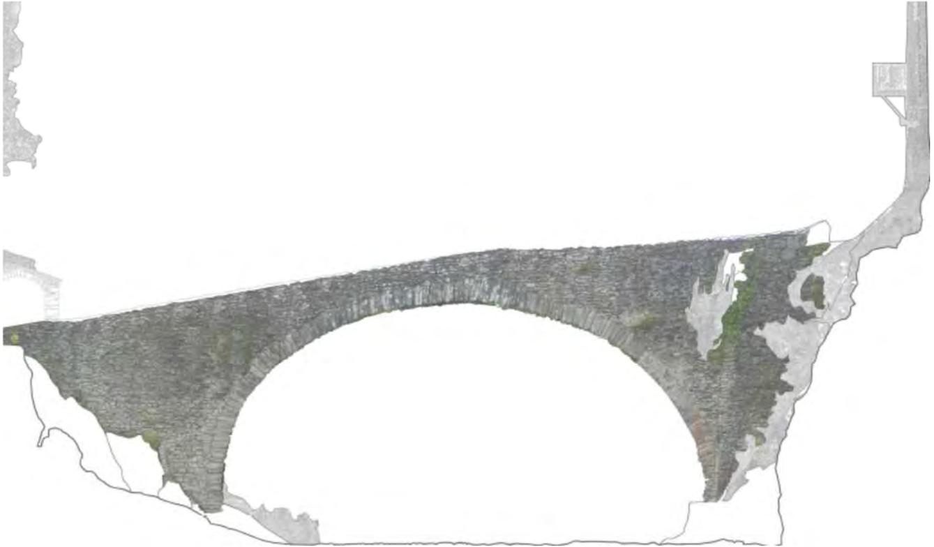
Fig. 5 e 5b – Nuvola di punti del Ponte di San Michele in Garfagnana – Fonte: elaborazione degli autori
